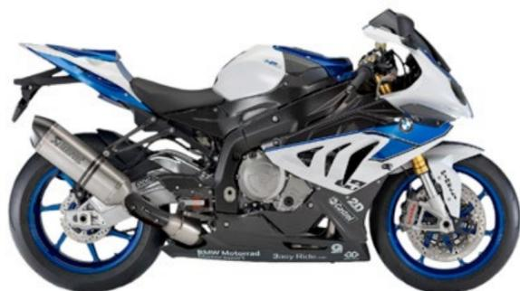
Una S1000RR hormonada. Más allá del ESA, las suspensiones electrónicas se adaptan de manera activa con el nuevo DDC (Dynamic Damping Control), autorregulándose gracias a sus sensores dependiendo del asfalto. Además, control de salida, un peso de 199 Kg y un pack "HP Race Parts" para competición.
